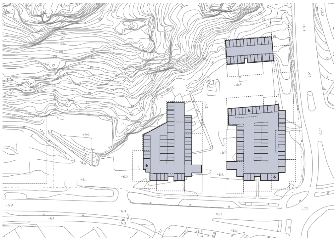
Figur 9. Parkeringslösning i garage, totalt 131 platser.
